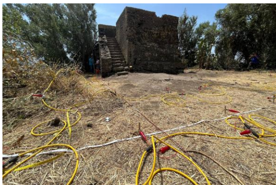
Geofisica applicata: stendimento di elettrodi per una tomografia elettrica (ERT).
