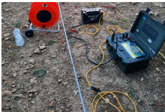
Strumentazione per tomografia elettrica: georesistivimetro e cavi multielettrodo.
